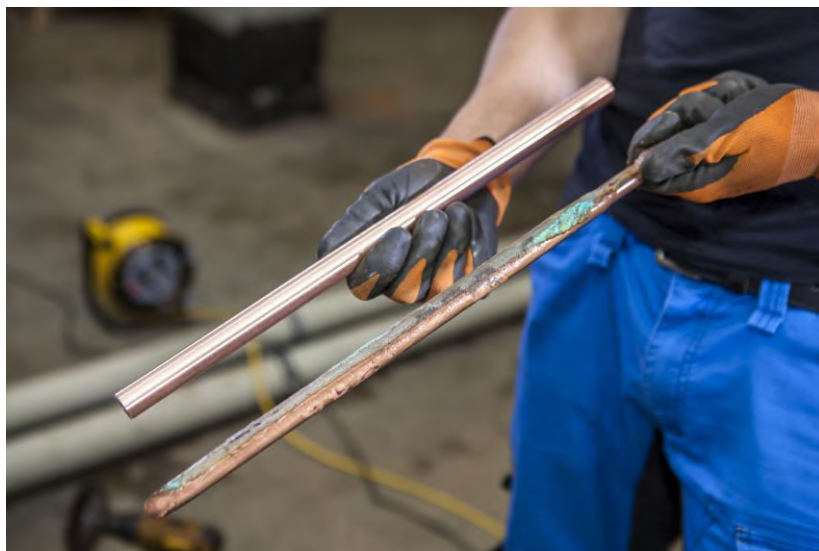
Obraz 26: Elektrody w trakcie eksploatacji ulegają zanieczyszczeniu oraz zmniejszają swoją masę. Z tego powodu wymagana jest regularna konserwacja, polegająca na czyszczeniu i wymianie elektrod. Na zdjęciu widoczne są dwie elektrody miedziane: nowa oraz po 3 miesiącach eksploatacji.
