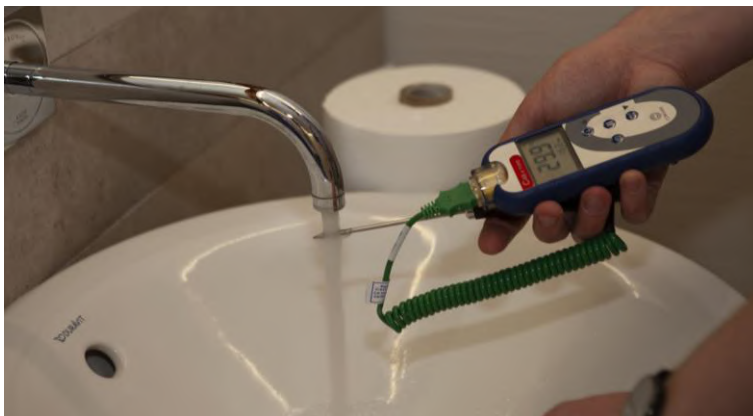
Obraz 12: Pomiar temperatury wody w trakcie oceny ryzyka dokonuje się przy pomocy certyfikowanego termometru igłowego. Na użytek własny można wykorzystać np. termometr kuchenny.
